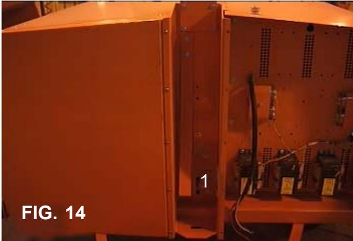
**FIG. 14 KICKOUT SPRING**
