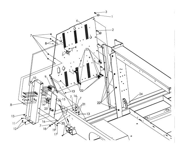
C-7C2 ISUZU 4-LIGHT AC GAUGE PANEL ASSEMBLY (3 PHASE)
