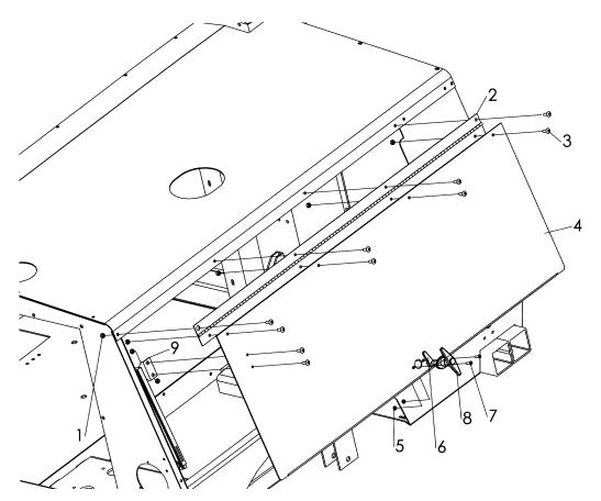
C-13A2 RIGHT DOOR PANEL ASSEMBLY (SLAM LATCH MODEL)
